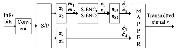
Fig. 1. Structure of the 16-QAM BICM-ID transmitter.
